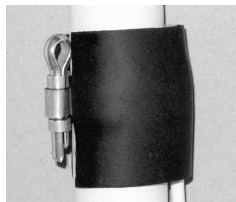
Izolace čidla termo- izolační páskou
