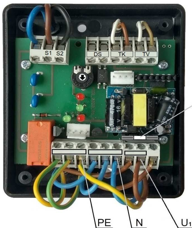
Obr. 8 Zapojení kabelu a vyjmutí propojky SW2
